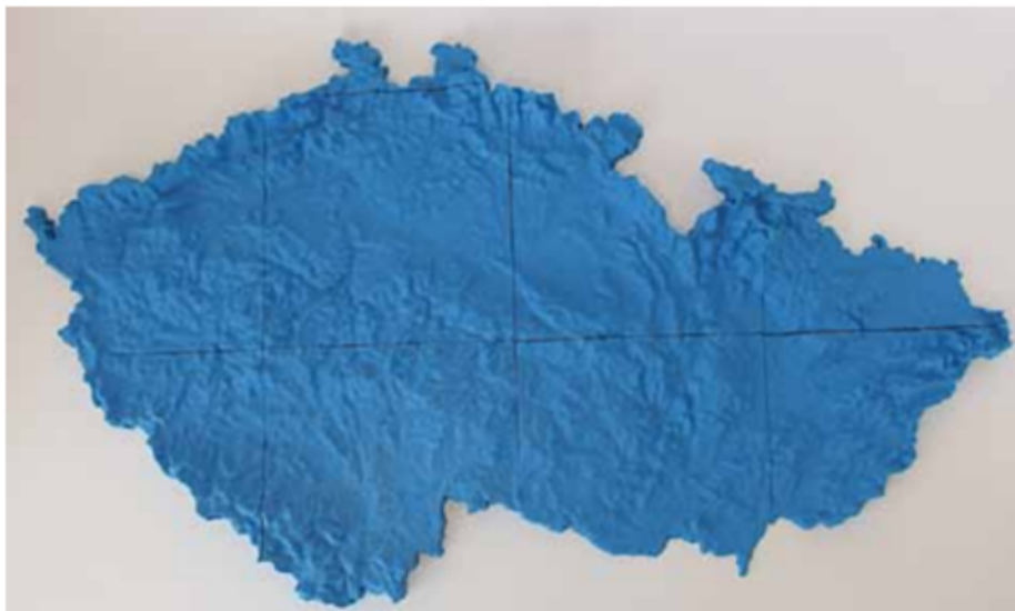
Obrázek 19 Digitální model reliéfu Česka vytištěný na 3D tiskárně Prusa i3. Velikost modelu 700 × 400 × 32 mm. Zdroj: Brus a Barviř 2016.
