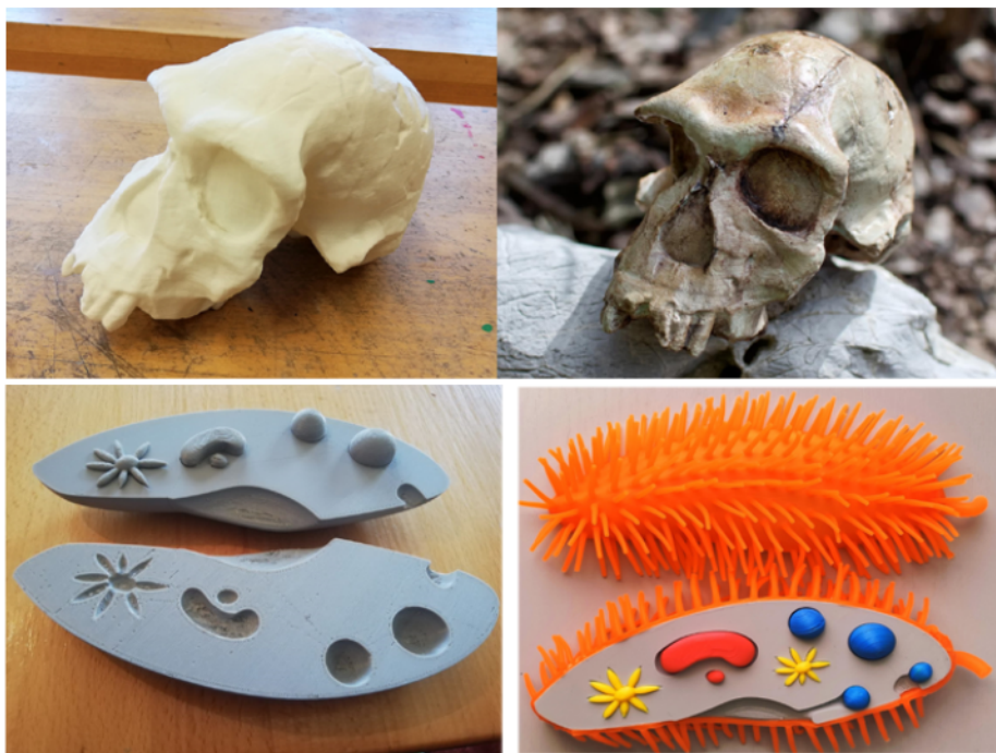
Obrázek 8 Model lebky před a po proběhnutí povrchové úpravy; model trepky před a po proběhnutí povrchové úpravy a použití barevných filamentů.
